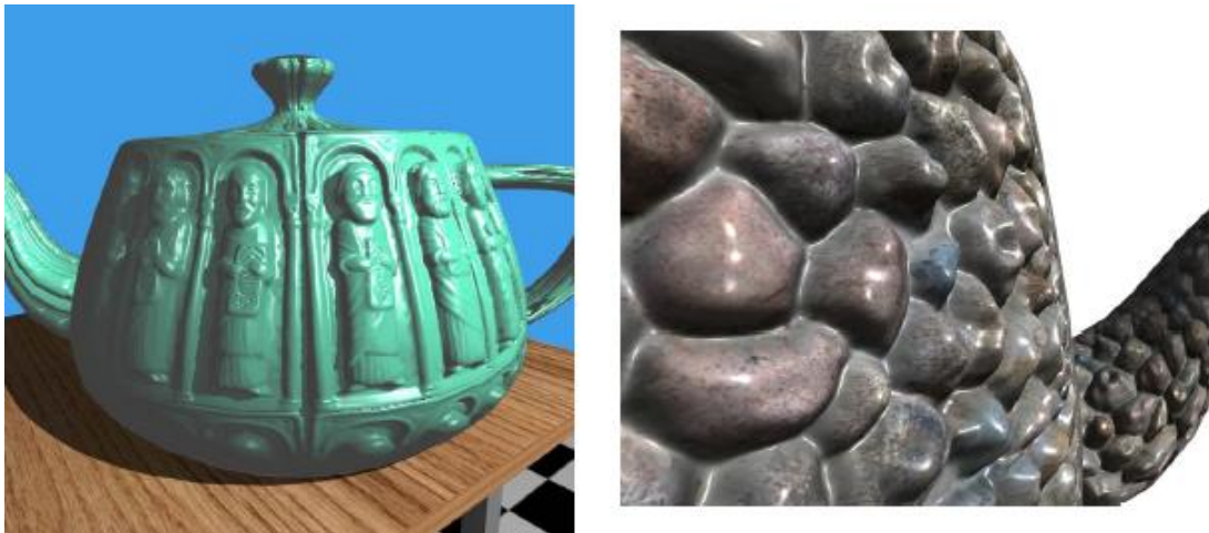
Figura 3.12: Aplicação do Relief Mapping em superfícies arbitrárias. Diferentes mapas aplicados a uma chaleira (POLICARPO; OLIVEIRA; COMBA, 2005).
